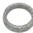
86053 D1= \Phi 51.5mm D2= \Phi 66mm Height= 14mm OEM: 7700781679
