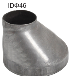
IDΦ46 Φ100 EC009 Height = 70mm SUS409
